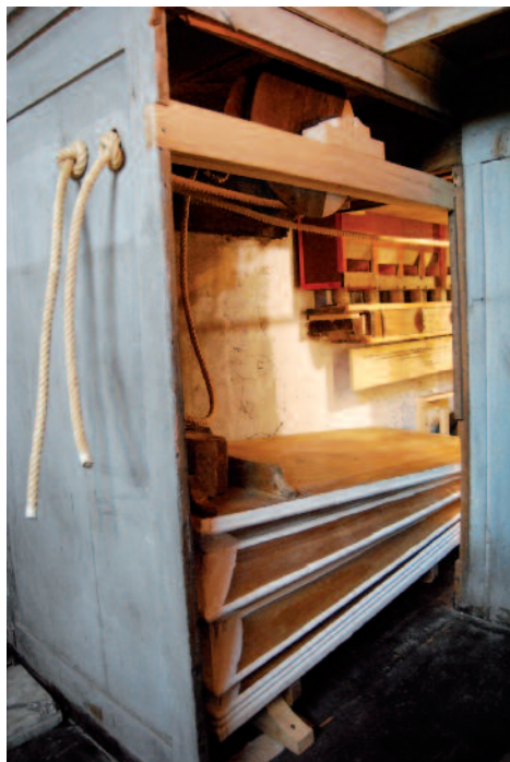
10. Mantice sinistro (si notino le corde per l'azionamento manuale, ricostruito).
