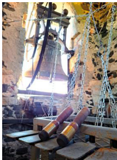
Una tastiera per il suono a festa delle campane secondo il metodo ligure e un primo piano dei pestelli.
