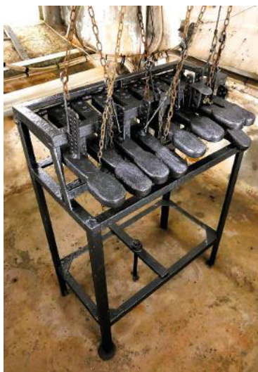
Una tastiera per il suono a festa delle campane secondo il metodo ligure e un primo piano dei pestelli.
